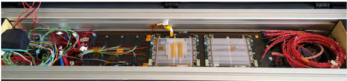
Abbildung 54: Verwendeter Aufbau für die Messung mit zwei simultan betriebenen Modulen. Das linke Modul wird ausgelesen.
